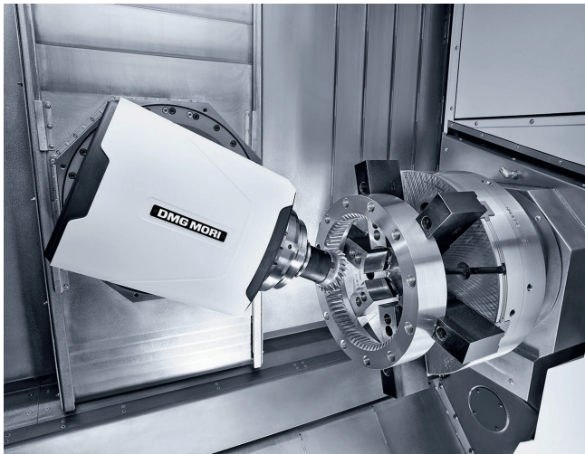
3 Technologieintegration Verzahnung: Komplettbearbeitung auf 5-Achs-BAZ, 'Turn & Mill'-Maschinen und Fräsdrehzentren
